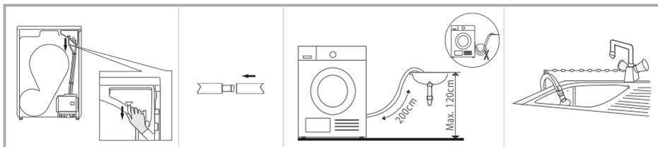
Снимите сливной шланг с корпуса.
