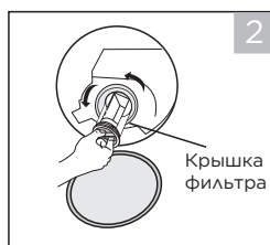
Откройте крышку фильтра, повернув против часовой стрелки
