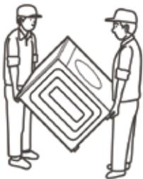
Во избежание травм или перенапряжения пользуйтесь защитными перчатками при подъёме и переноске устройства.
