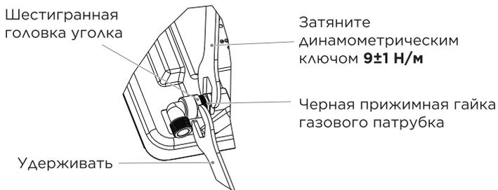
После ослабления уголка поверните его во внешнем направлении и удерживайте шестигранную головку уголка неподвижно с помощью гаечного ключа.
