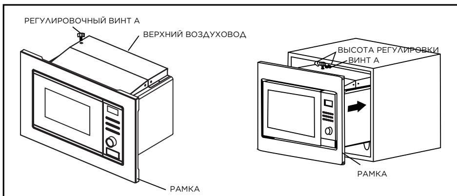
1. Ввинтите регулировочный винт А в верхний воздуховод печи. Вставьте пек в установочную нишу.
