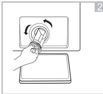
После слива воды и отключения питания, надавите на фиксатор и откройте крышку сливного фильтра.
