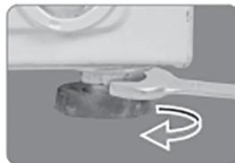
**Примечание:** нажмите на все углы прибора, и если он качается, отрегулируйте ножки.
