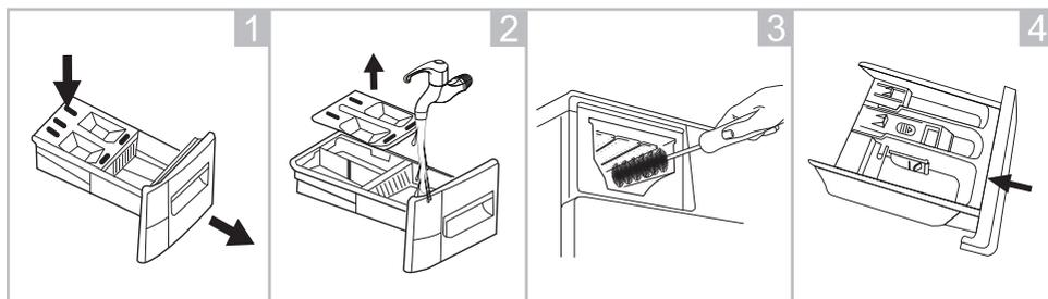
Выньте лоток для моющих средств, нажав на кнопку отсоединения и одновременно потянув лоток на себя.
