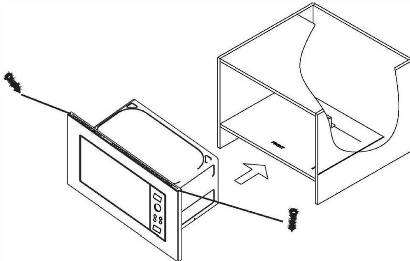
1. Поставьте микроволновую печь в шкаф и держите ее в горизонтальном положении, сохраняя одинаковые зазоры между стенками. Затем установите винты (компонент 1) на верхней части микроволновой печи и закрутите их к кухонному модулю.
