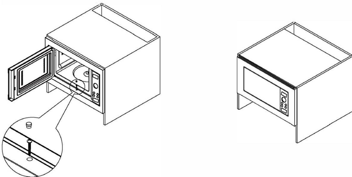
2. Откройте микроволновую печь, установите винт (компонент 3) и прикрутите его к кухонному модулю, затем установите заглушку.
