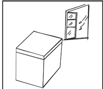
Морозильник должен быть установлен на ровную и твердую поверхность и располагаться в хорошо вентилируемом помещении.
